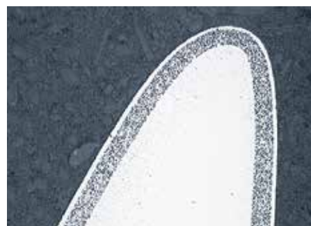
Querschliff durch eine mit 3M™ Verschleißschutz beschichtete Zahnspez
