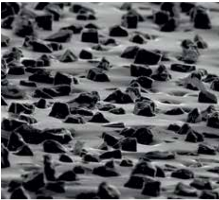
Oberflächenstruktur von 3M™ Reibwerterhöhenden Scheiben
